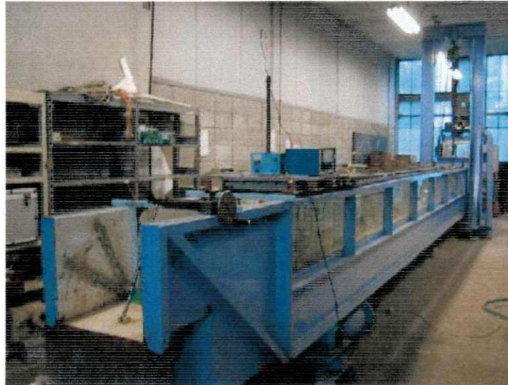
Figura 3.1 - Canal experimental de aço e com paredes de vidro temperado.
