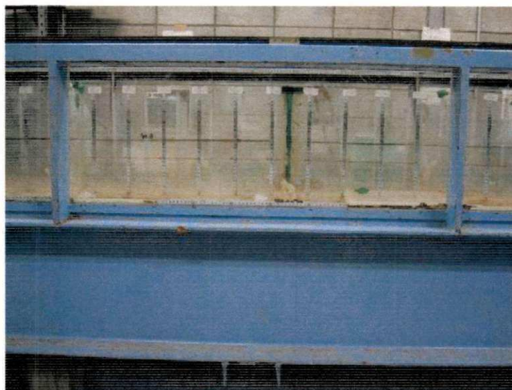
Figura 3.2 – Régua limimétrica distribuídas ao longo do canal.
