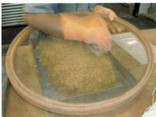
Figura 3.16 – Preparação das amostras para os ensaios da metodologia MCT
