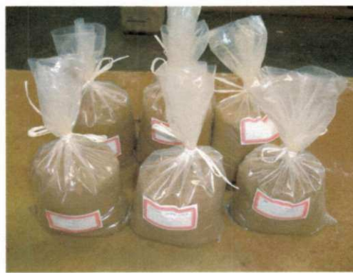
Figura 3.16 – Preparação das amostras para os ensaios da metodologia MCT
