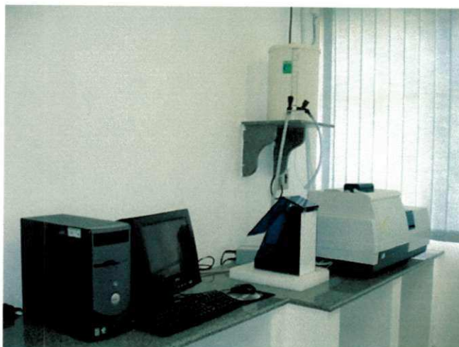
Figura 3.6 - Equipamentos utilizados para realização do ensaio de difração a laser [Laboratório de Caracterização de Materiais – UFCG (2007)]
