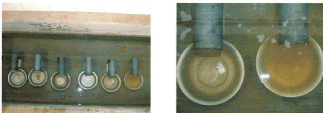
Figura 3.17 – Detalhe do ensaio de perda de massa por imersão
