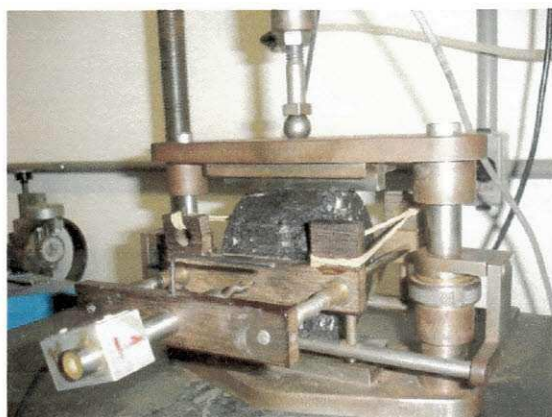
Figura 3.11 - Equipamento utilizado para realização do ensaio de módulo de resiliência
