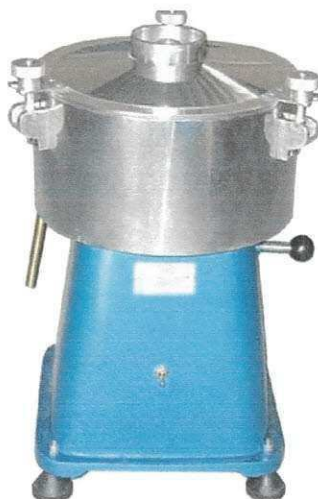
Figura 3.7 – Extrator de asfalto utilizado (Rotarex)
