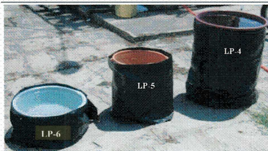
Figura 3.2 – Lagoas de polimento LP-4, 60 , LP-5, 40 e LP-6, 20 , utilizadas para obtenção da constante de dessorção de \text{NH}_3 .
