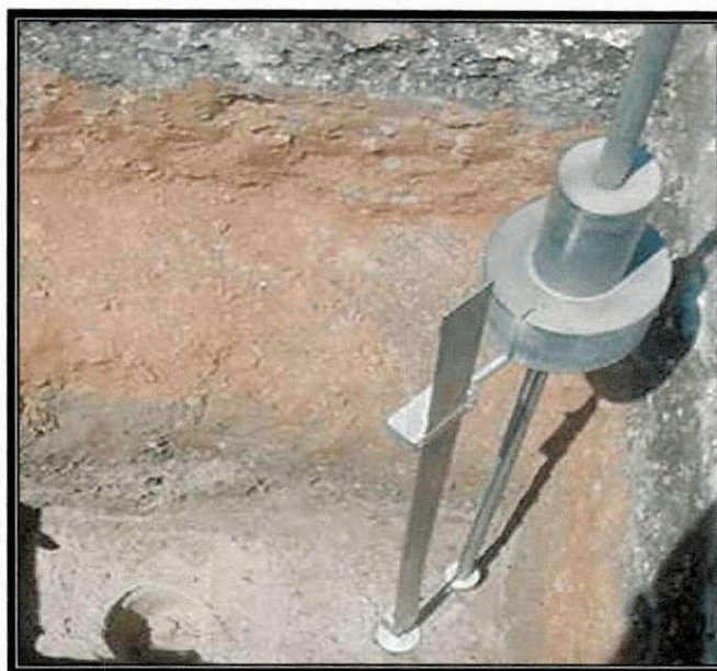
Figura 3.10 – Posicionamento do DCP para início do ensaio.
