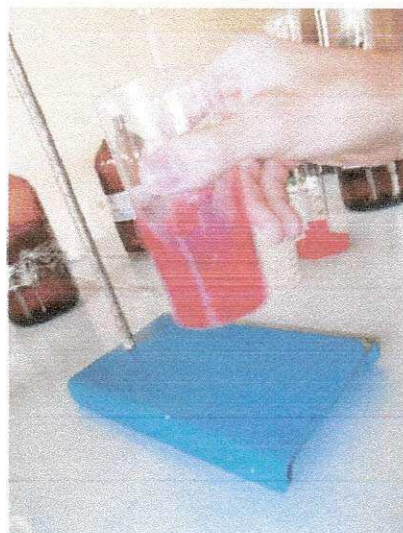
Figura 4.13 - Detalhe da execução do método DPD-SFA
