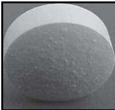
Figura 7: Superfície do comprimido da amostra S3 com rugosidades. Fonte: Dados da pesquisa.
