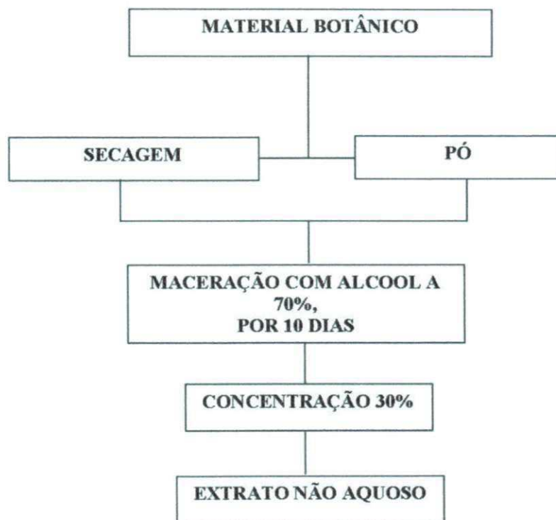
Figura 6. Fluxograma para a obtenção de extratos vegetais hidroalcoólico de angico, pereiro e oiticica.
