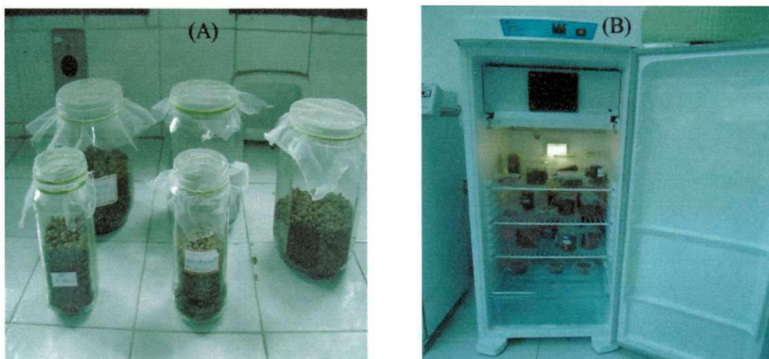
Figura 5. Recipientes de vidro tamponados com voil (A) e BOD com temperatura controlada (B).
