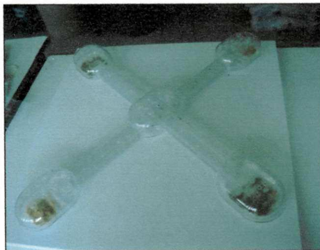
Figura 8. Arena utilizada em testes de repelência/atratividade e mortalidade com insetos Zabrotes subfasciatus .
