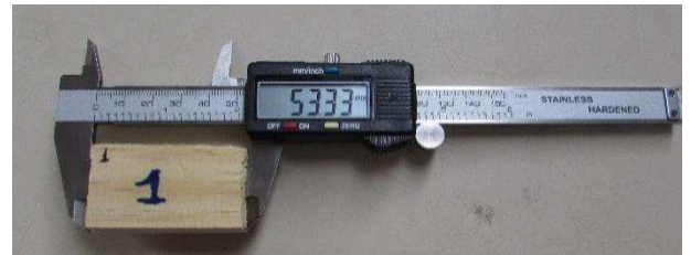
Figura 12. Determinação das dimensões dos corpos de prova com paquímetro para determinação da densidade. Fonte: Da autora
