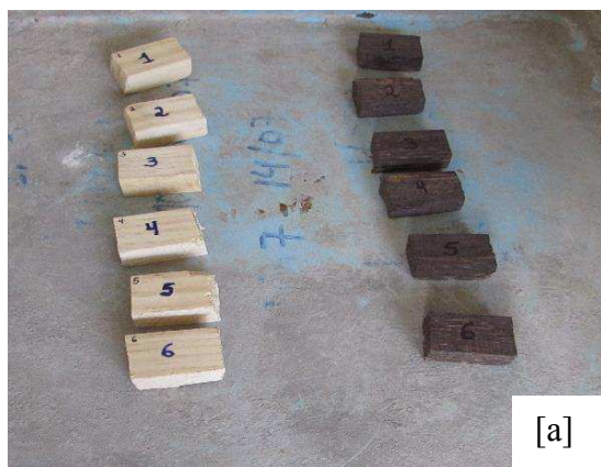
Figura 9. Identificação e pesagem dos corpo-de-prova [A] Corpo-de-prova de pinus e macaúba [B] Determinação da massa do corpo de prova para ensaio do teor de umidade e densidade básica.
