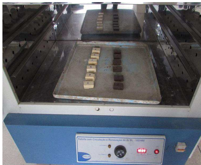
Figura 10. Corpos-de-prova na estufa com circulação e renovação de ar, modelo SL-102/480 – da marca SOLAB.
