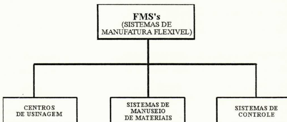
Figura 3.2 Elementos básicos de um Sistema de Manufatura Flexível
