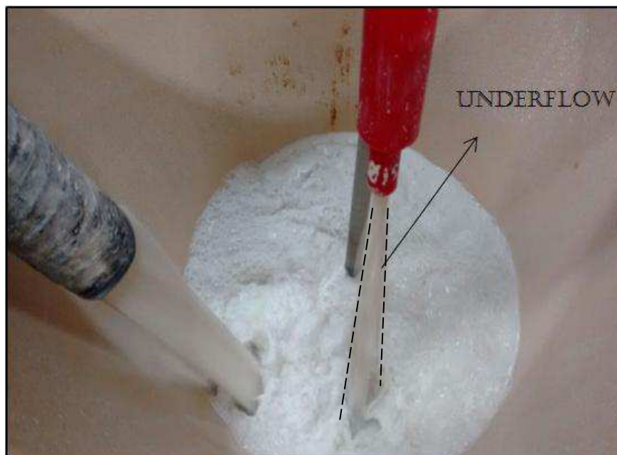
Figura 22 - Ensaio de hidrociclonação, em destaque a descarga do underflow em formato de um cone de pequeno ângulo.
