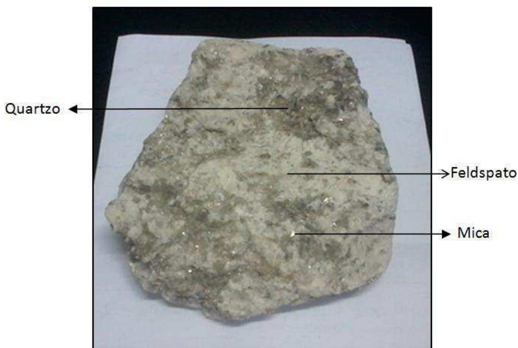
Figura 2 - Amostra de pegmatito da ocorrência Galo Branco - Equador /RN, com destaque para os principais minerais.
