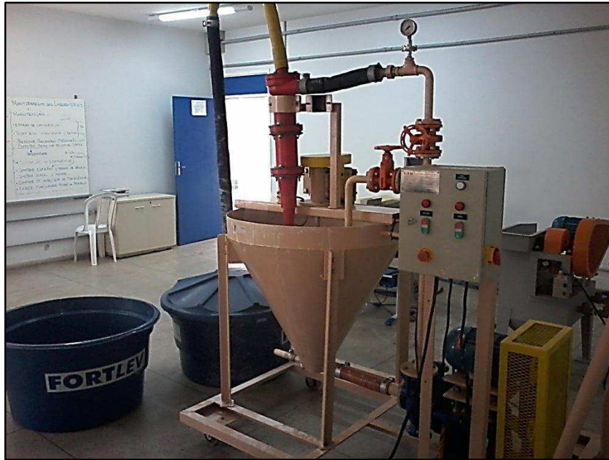
Figura 17 - Unidade piloto portátil de hidrociclonagem no Laboratório de Tratamento de Minérios do IFPB, campus Campina Grande
