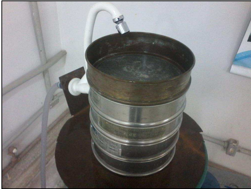
Figura 19 - Sistema de peneiramento a úmido desenvolvido pelo autor no laboratório de tratamentos de minérios do IFPB, Campus Campina Grande
