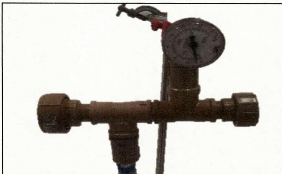
**Foto 3** - Módulo com membrana cerâmica de microfiltração (Fonte: Elaborada pela autora).
