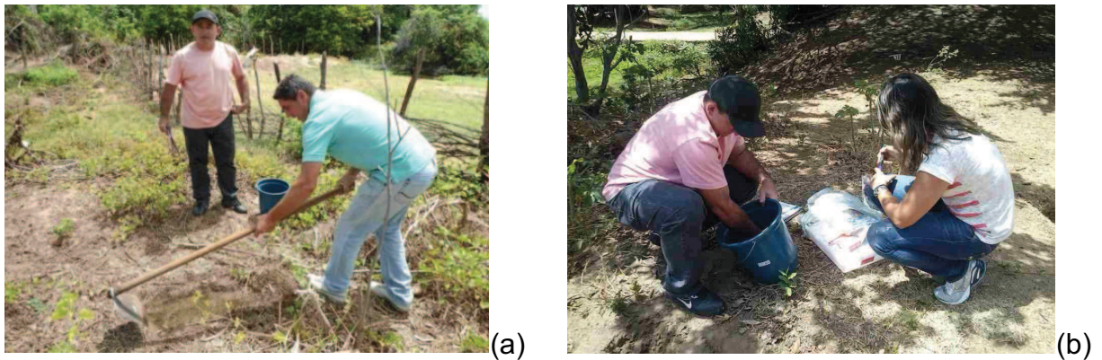
Figura 6 - Obtenção das amostras de solo superficial (a) e homogeneização (b).
