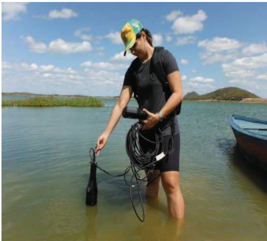
Figura 7 – Sonda multiparâmetros utilizada em campo para coleta de dados físico-químicos da água.
