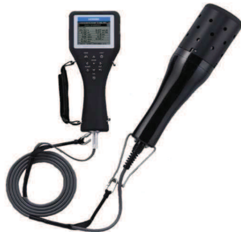
Figura 7 – Sonda multiparâmetros utilizada em campo para coleta de dados físico-químicos da água.
