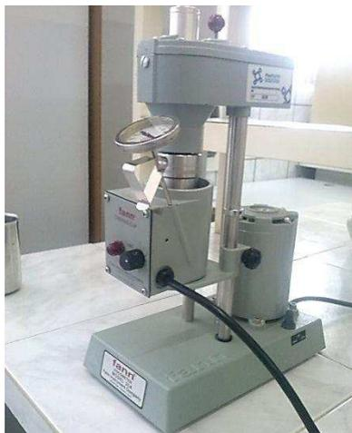
Com os dados das leituras obtidas no viscosímetro (Figura 15), calculou-se a viscosidade aparente (VA), a viscosidade plástica (VP), o limite de escoamento (LE) e a força gel (FG) segundo a norma EP-1EP-00011-A (PETROBRAS, 2011b) utilizando as equações (1). (2). (3) e (4), respectivamente.
