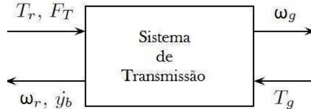
Figura 3.5: Entrada e saída do subsistema mecânico
