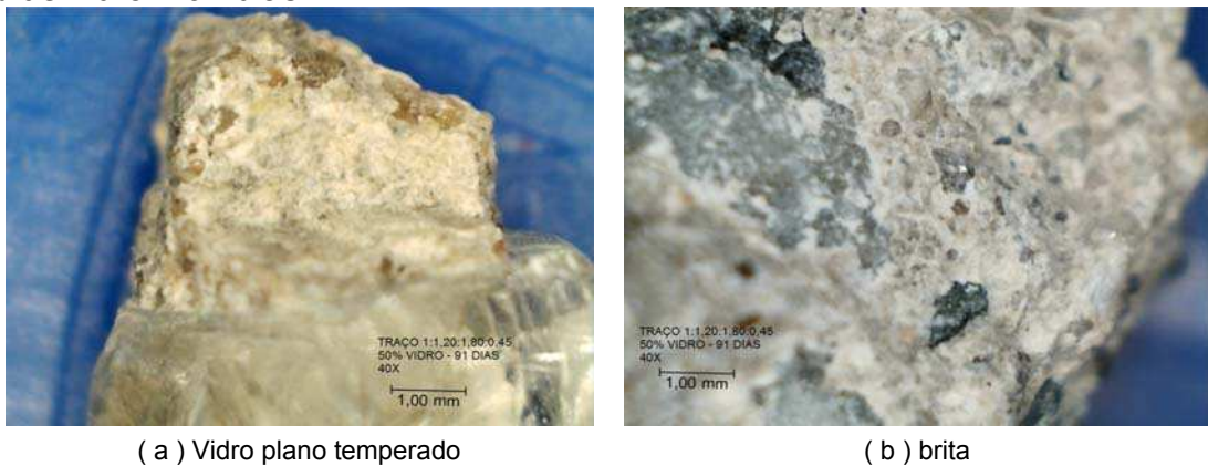
Figura 4.15 - Agregado graúdo - produto da desagregação da pasta cimentícia – 50% de vidro – 91 dias
