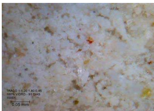
Figura 4.17 - Pasta cimentícia desagregada e peneirada em malha ASTM 200 – 50% de vidro – 91 dias
