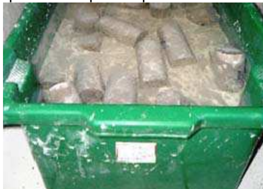
Figura 3.6 – Câmara úmida para os corpos de prova de concreto
