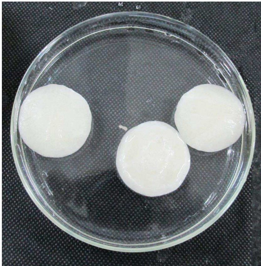
Figura 19 - Arcabouços de quitosana em solução de tripolifosfato de sódio.
