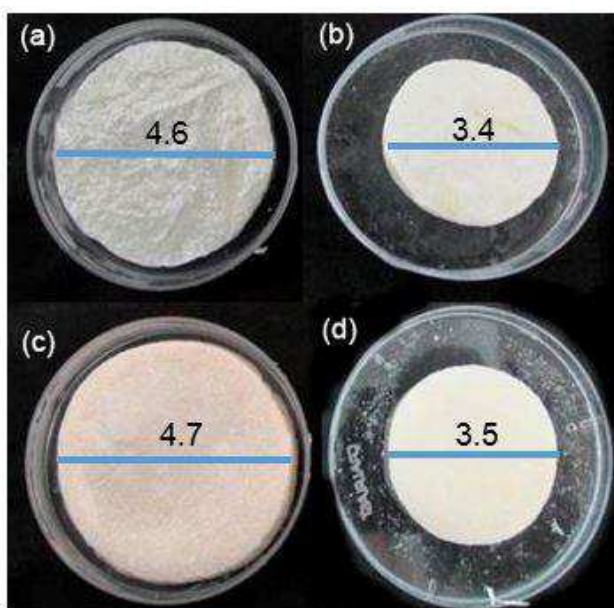
Figura 30 -Medidas dos diâmetros (cm) dos arcabouços de Q (a), QT (b), QN (c) e QNT (d).
