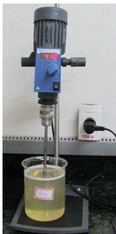
Figura 16 - Preparação da solução de quitosana sob agitação mecânica.
