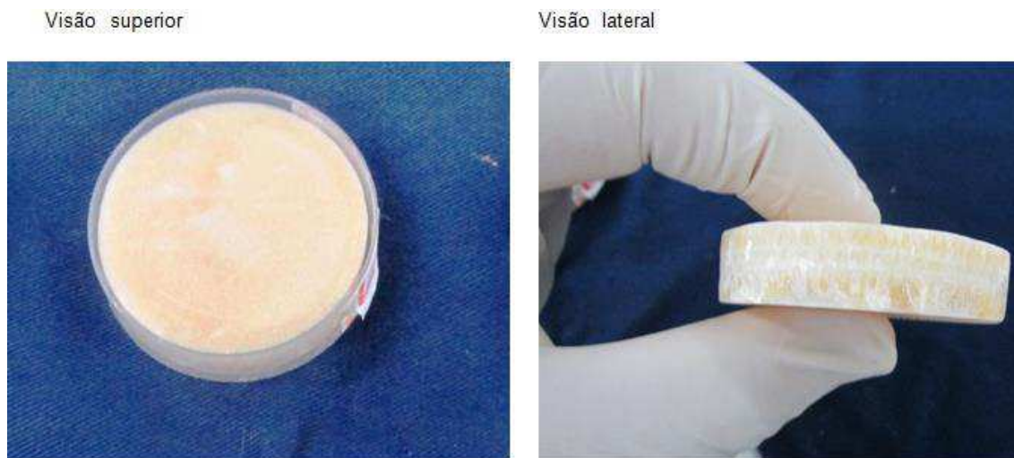
Figura 22 - Arcabouços de quitosana com 1,4 Naftoquinona com camadas invertidas após liofilização. Vista superior e Vista lateral.
