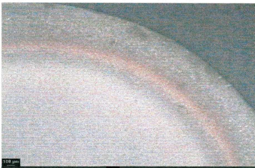
Figuras (4.1) – Aspecto visual da superfície das amostras, destacando-se a formação de anéis de erosão. Amostras de 10mm nitretadas sob pressão de 500 Pa à temperaturas de 843 K (a) e 773 K (b).
