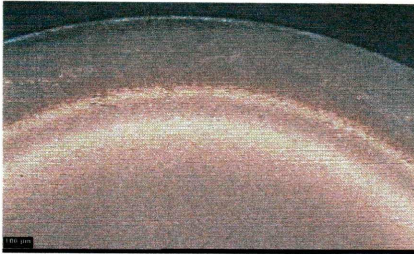
Figura 4.2 – Aspecto visual da superfície da amostra de 5 mm de altura , nitretada sob pressão de 500 Pa à temperatura de 773 K, destacando-se a formação de vários anéis.
