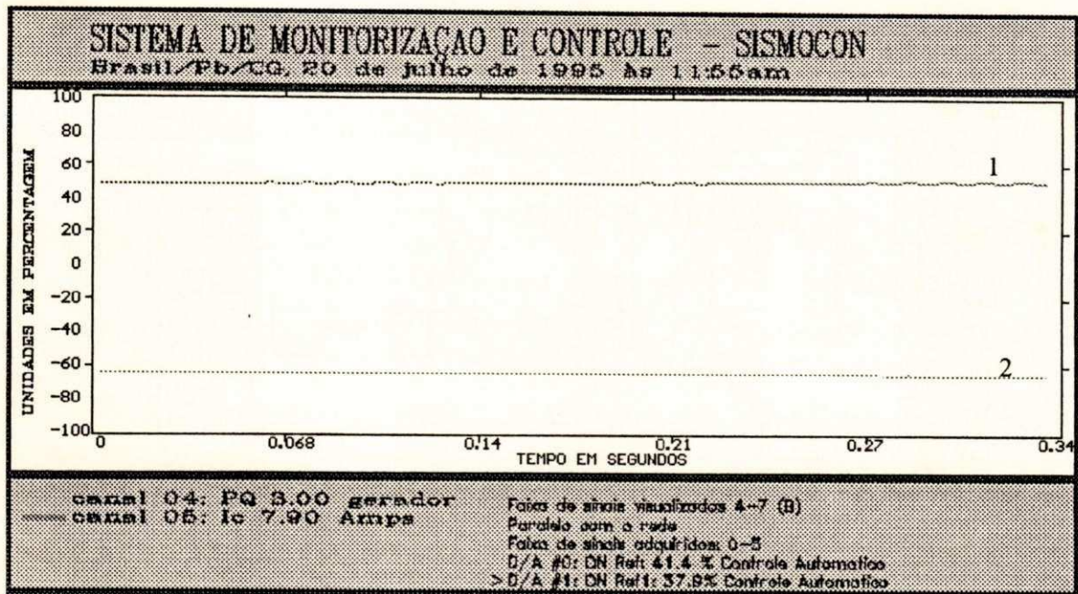
Figura 5.5 Controle da potência ativa, regime permanente (ajuste de 53% da potência ativa máxima), curva 1 = potência ativa, curva 2 = potência reativa
