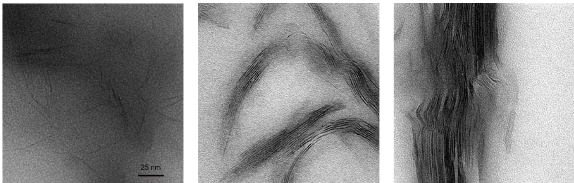
Figura 5 - Micrografias de MET de (a) nanocompósito esfoliado, (b) nanocompósito intercalado e (c) não-intercalado (fase separada) ou microcompósito. Adaptado de: Mittal (2009).
