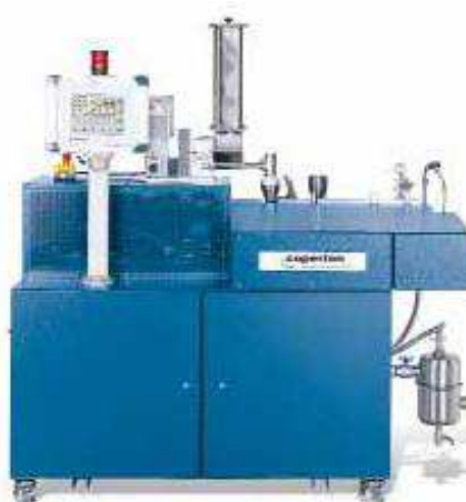
Figura 28 – Extrusora dupla rosca co-rotacional Werner-Pfleiderer ZSK-18.
