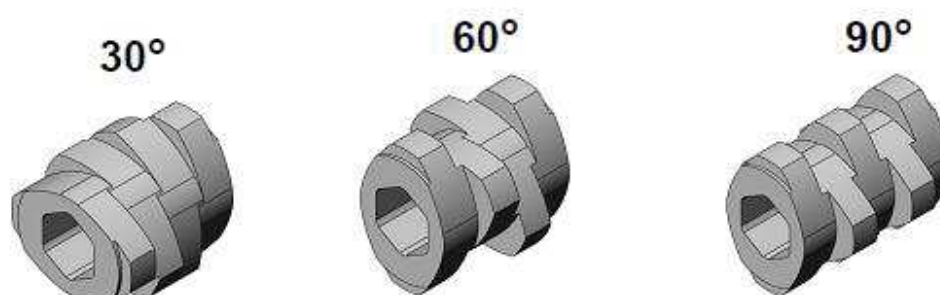
Figura 10 - Elementos de Malaxagem de 30, 60 e 90°.
