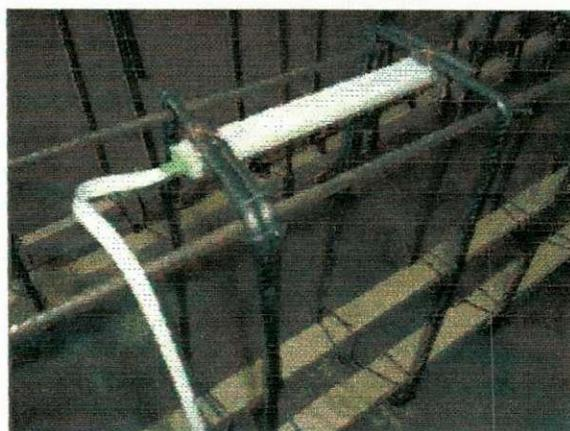
Figura 88: Extensômetros utilizados para se obter as deformações do concreto
