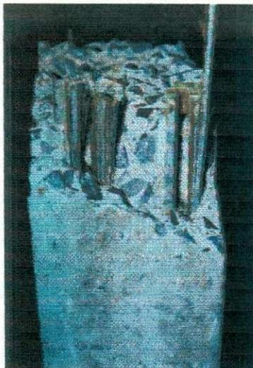
Figura 101: Concentração de tensões provocadas pelos pinos
