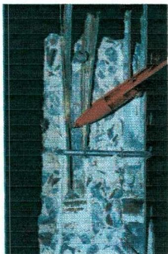
Figura 102: Redução da secção devido a cravação dos pinos
