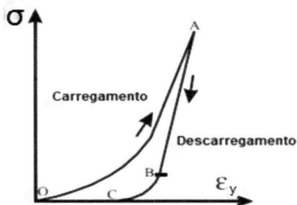
Figura 14 - Diagrama de carga e descarga
