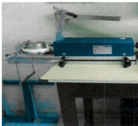
Figura 12 - Célula de cisalhamento direto e aparelho (TSG 70-140)
