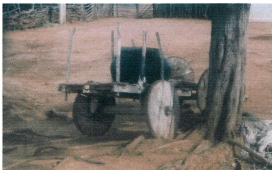
Figura 10 - Carro de boi com rodas confeccionadas com madeira de angico, sendo o lastro e eixo de braúna de Classes Diamétricas variadas, Fazenda Araçá (Monteiro - PB).
