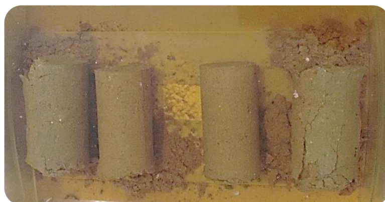
Figura 73 - Blocos imersos em solução de sulfato por 96h, respectivamente: RO, 15%RC, 15% RCER e referência
