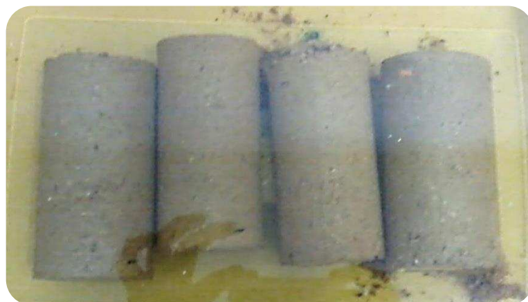
Figura 71 - Blocos imersos em solução de sulfato por 24h, respectivamente: referência, 15%RCER, 15%RC e RO
