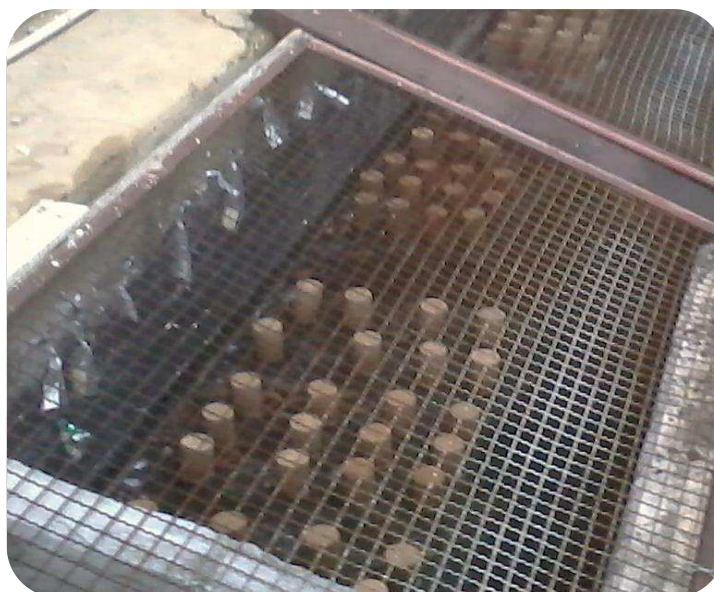
Figura 3 - Blocos solo-cal com e sem incorporação de resíduos submetidos às condições climáticas
