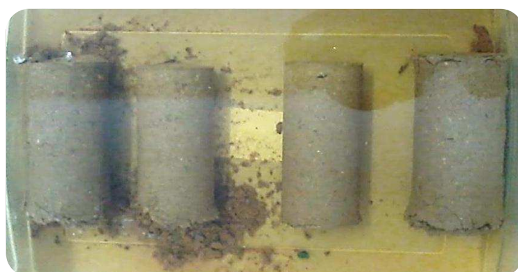
Figura 72 - Blocos imersos em solução de sulfato por 48h, respectivamente: RO, 15%RC, 15% RCER e referência
