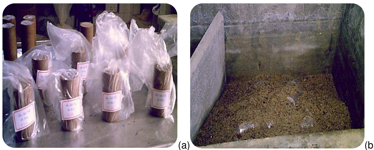
Figura 2 - Cura dos blocos: (a) Envolvidos em sacos plásticos; (b) Cobertos com areia úmida
