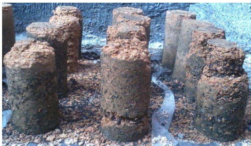
Figura 43 – Blocos solo-cal com incorporação de resíduo de rochas ornamentais submetidos ao envelhecimento natural
