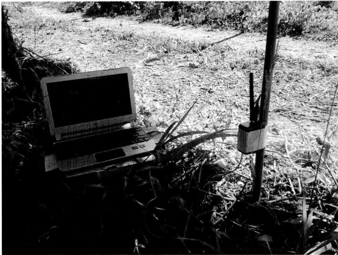
Figura 5.9 – Foto do nó coordenador conectado ao notebook .
