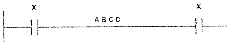
Fig. 2.4 - Esquema de compensação série mais usual.
