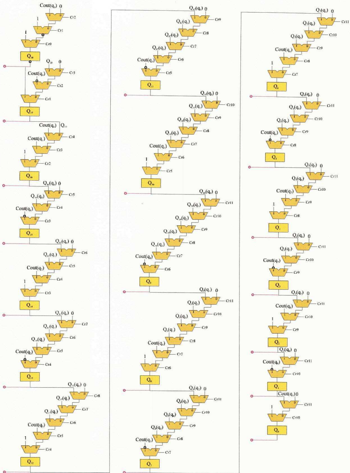
Figura 5.17 - Diagrama do Registrador Aritmético "Raiz Q".
