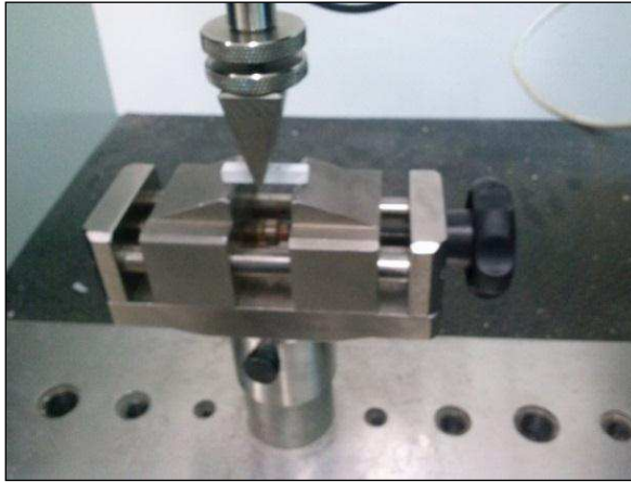
Figura 28 – Ensaio de flexão uniaxial 3 pontos
