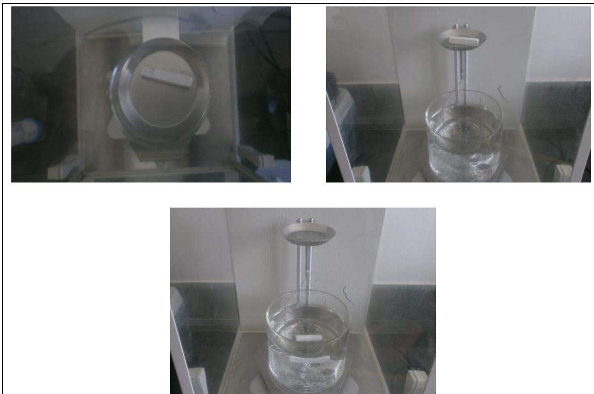
Figura27 – Balança analítica usada para obter os valores da massa úmida, massa imersa e massa seca para cálculo da porosidade pelo método de Arquimedes.
