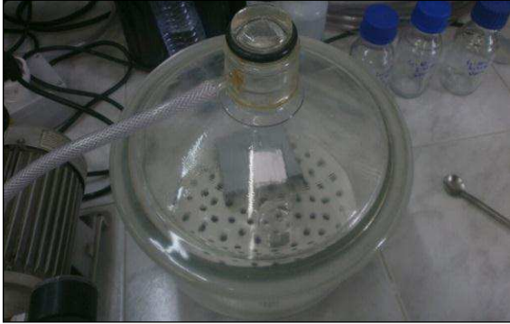
Figura 16 – Amostras de alumina na câmara a vácuo
