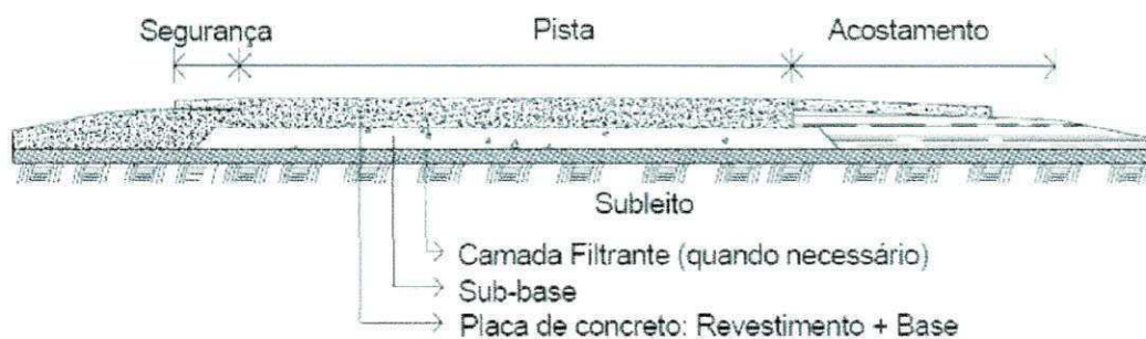
Figura 2.5 – Estrutura do pavimento rígido (Fonte: SILVA JÚNIOR, 2005).
