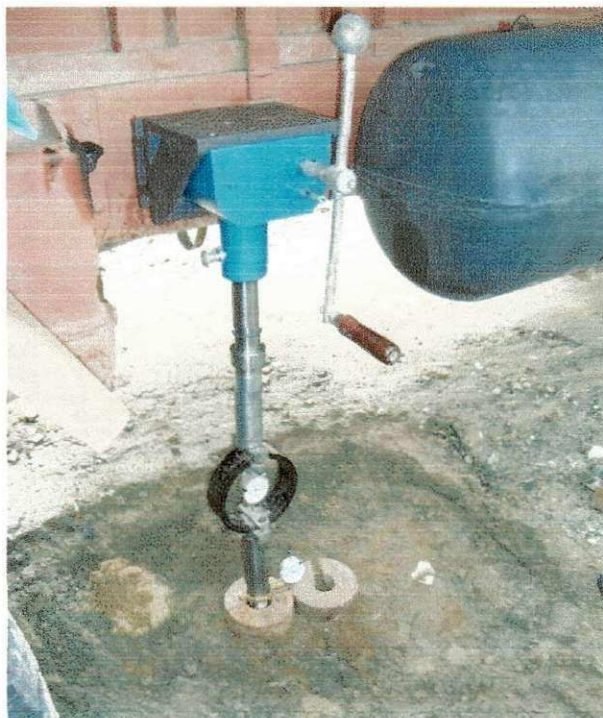
Figura 2.19 – Execução do ensaio de CBR “in situ”
