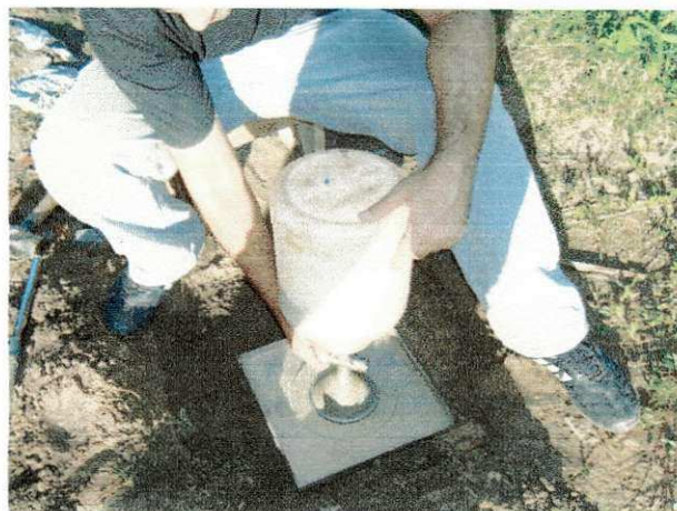
Figura 3.11 – Execução do ensaio com Frasco de Areia.
