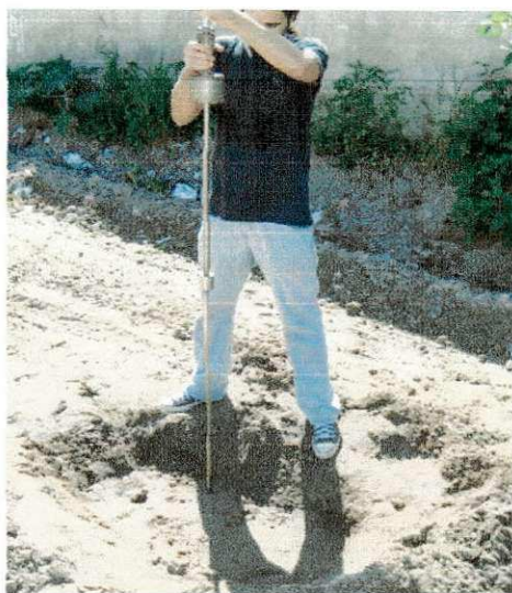
Figura 3.15 – Execução do ensaio de CPD.
