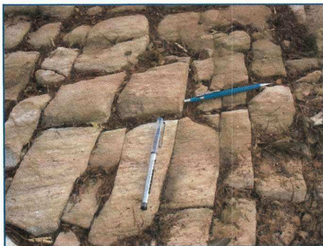
Figura 3.3 – Afloramento de rocha ígnea mostrando, densidade de fraturas ortogonais.
