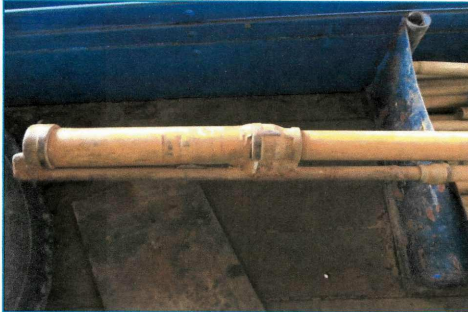
Figura 3.10 - Injetor acoplado com os tubos de quarenta e vinte milímetros
