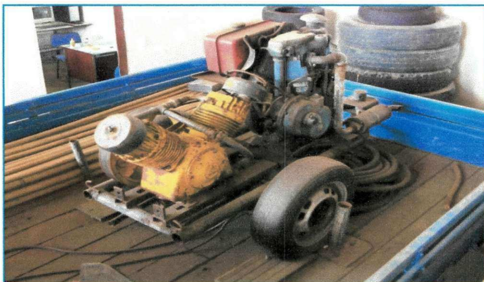
Figura 3.9 - Compressor acoplado com motor a diesel, ao seu lado, tubos de PVC de quarenta e vinte milímetros.
