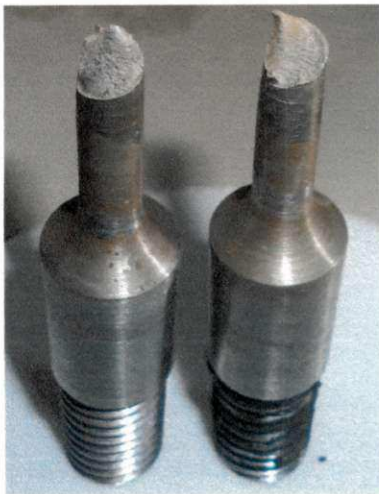
(a) (b) Figura 4.21 - Modo de fratura predominante nos testes de fragilização: (a) Junta A1.1 e (b) Junta A2.0.
