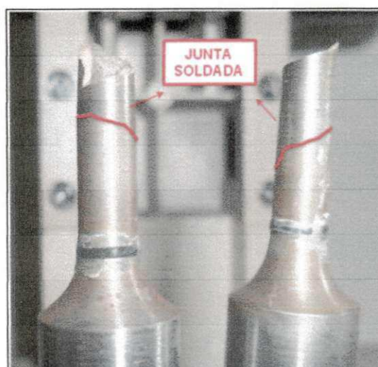
Figura 4.17 – Corpo de Prova rompido no Metal de Solda.
