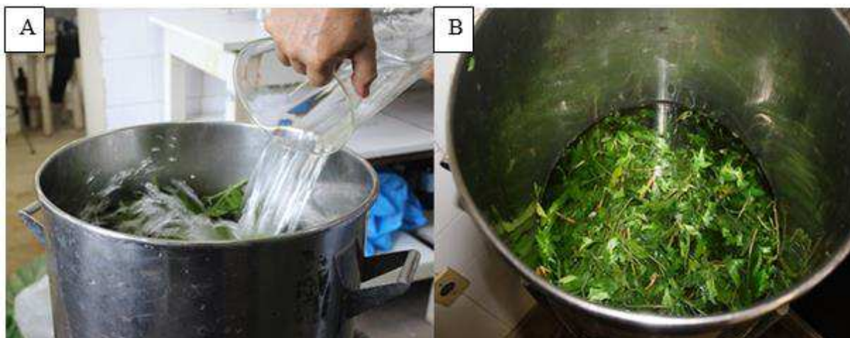
Figura 14 – Adição do etanol 95% (A) e o vegetal com etanol deixados em repouso (B) (Autor, 2016).
