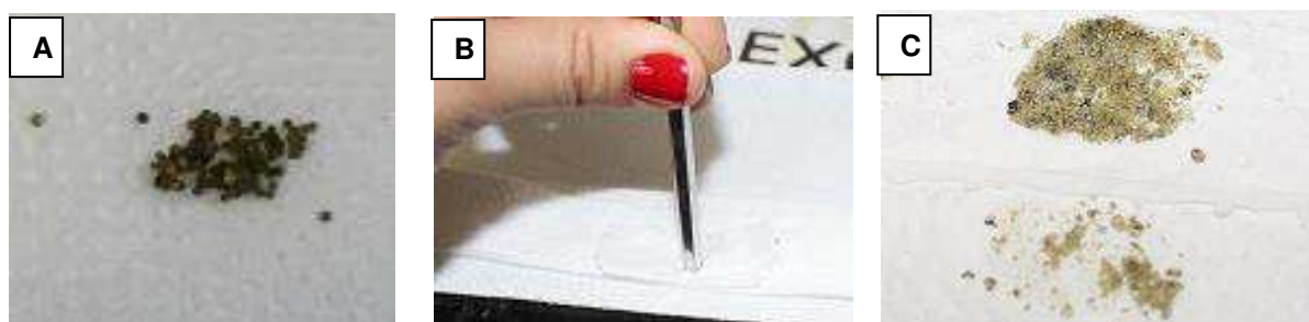
Figura 27 – Processo de trituração das esferas para o FTIR. Esferas inteiras (A), Trituração das mesmas com odontoscópio (B) e aspecto final das esferas após trituração (Autor, 2016).
