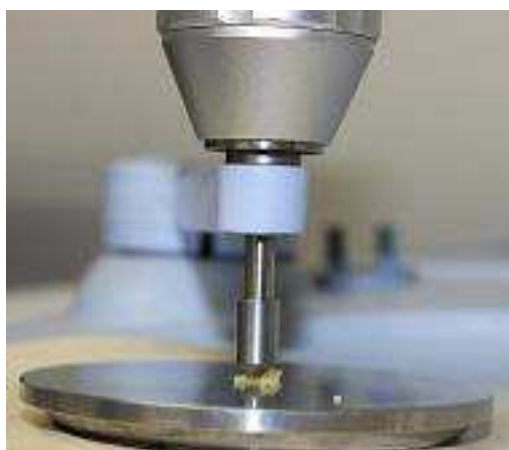
Figura 28 – Ponteira do FTIR espalhando as esferas inteiras. Esferas inteiras (A), Trituração das mesmas com odontoscópio (B) e aspecto final das esferas após trituração (Autor, 2016).
