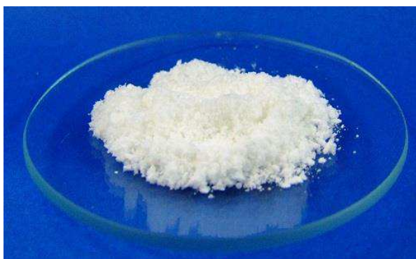
Figura 48 – Aspecto físico das esferas de PCL/nHA (Etapa 02) obtidas por emulsão sólido/óleo/água.
