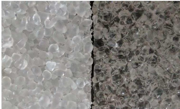
Figura 29 - Pastilhas brancas sobre fundo preto, obtidas por: (a) TT3; (b) TT4.
