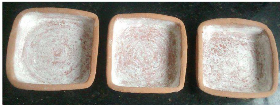
Figura 8 - Moldes de cerâmica vermelha, polvilhados com caulim.
