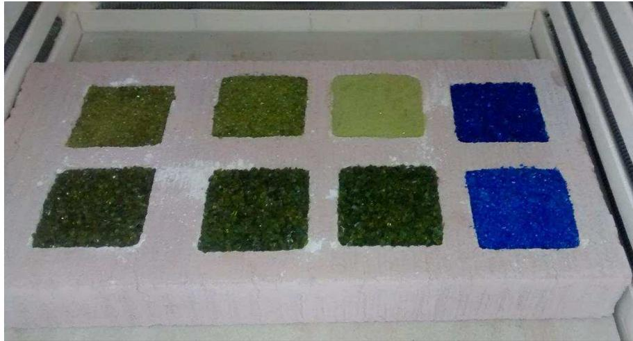
Figura 18 - Bloco de CCA antes de ser submetido à tratamento térmico, no interior do forno.
