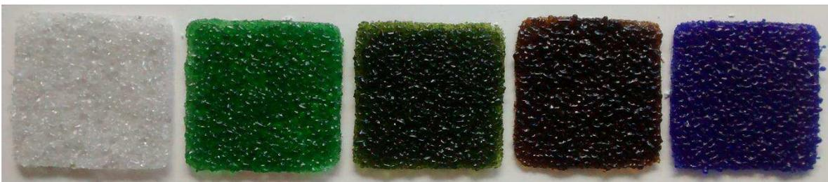
Figura 33 - Pastilhas aplicadas sobre superfície de gesso com argamassa autofugante.
