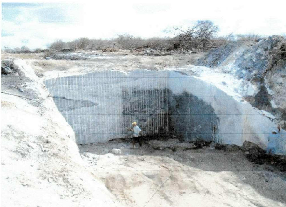
Foto 10 - Laterais cortadas a fio e prancha liberada por furação e argamassa expansiva.
