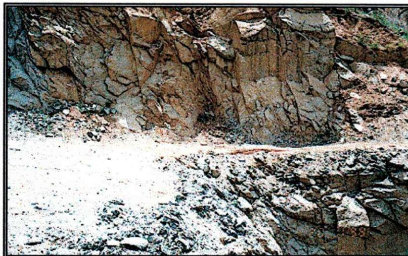
Figura (5.17) Face da bancada extremamente fraturada
