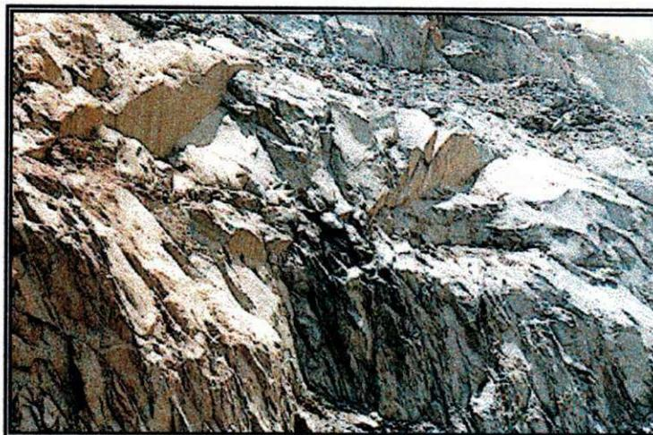
Figura (5.18) Juntas semi-paralelas tangenciais a foliação
