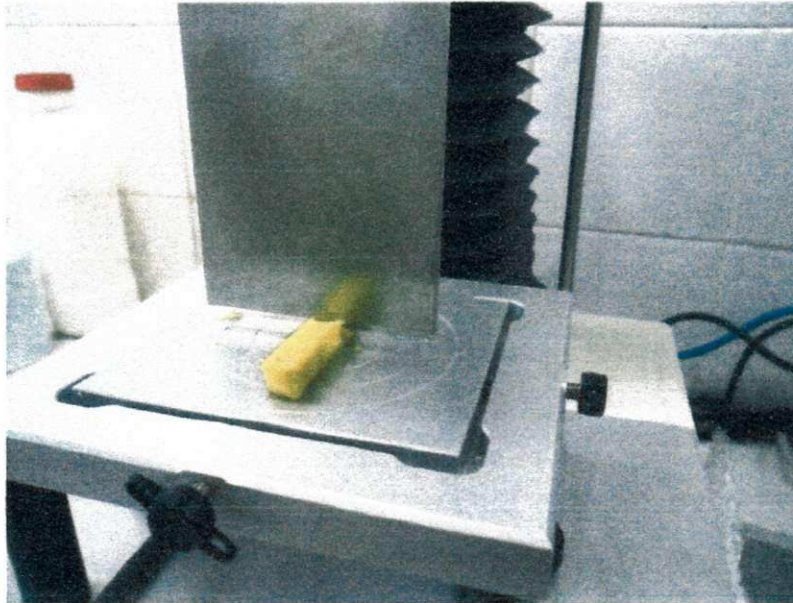
Figura 3.9 – Teste de penetração com corte utilizando-se o probe HDP/BSK
