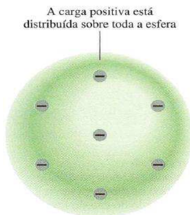
Figura 4: O modelo de Thomson, às vezes descrito como o modelo de “pudim de passas”, uma sobremesa tradicional inglesa. Os elétrons estão embutidos em uma esfera com carga positiva distribuída uniformemente.
