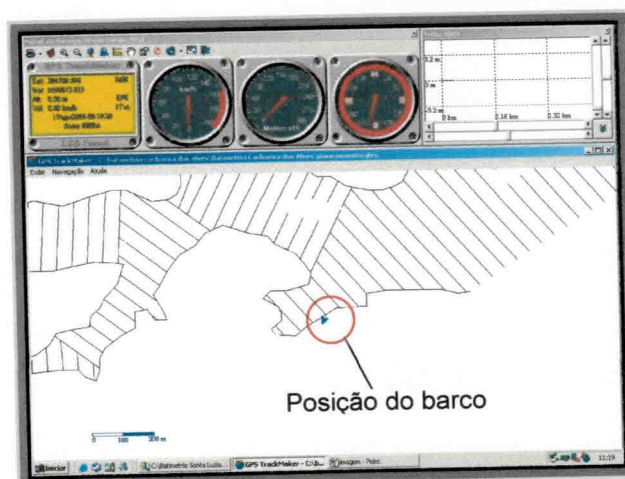
Figura 3.13- Tela ilustrativa de navegação para levantamento das seções Fonte: Guimarães, 2006
