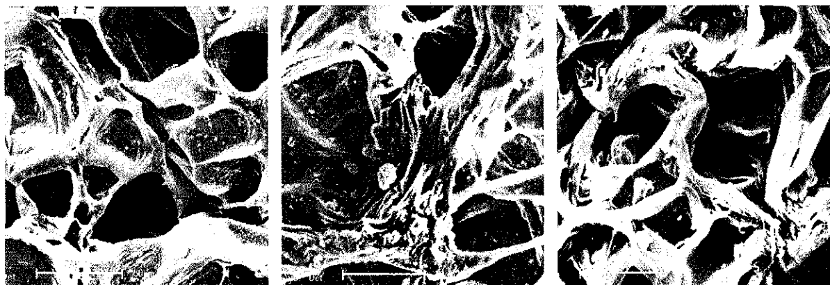
Figura 50. Espuma de EVA ampliada 350 X: (a) 45 pcr de PCC Barralin, \phi 1,7 \mu\text{m} ; (b) 45 pcr de PCC Barraleve, \phi 5,9 \mu\text{m} ; (c) 45 pcr de NCC EDK 400, \phi 8,3 \mu\text{m}
