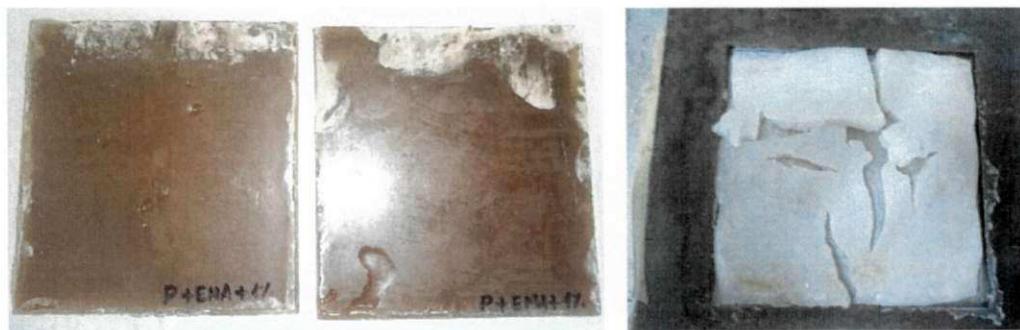
Figura 17. Placas fraturadas de PMMA/EMA/Argila e PMMA/EGMA, respectivamente.
