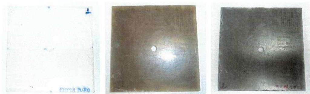
Figura 16. Placas obtidas por prensagem de PMMA Puro, PMMA com 3% de argila e PMMA com Alumina da UFCG, respectivamente
