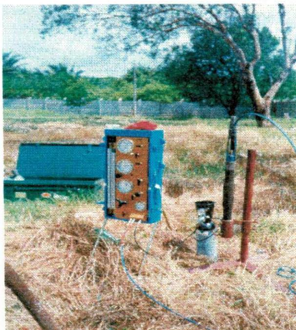
**Figura 3.4-** Conjunto do ensaio pressiométrico utilizado na campanha de ensaio, modelo GC, da APAGEO.
