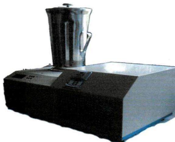
Figura 3.1-Equipamento que simula os danos mecânicos das sementes para as diversas etapas do processo de beneficiamento em uma UBS
