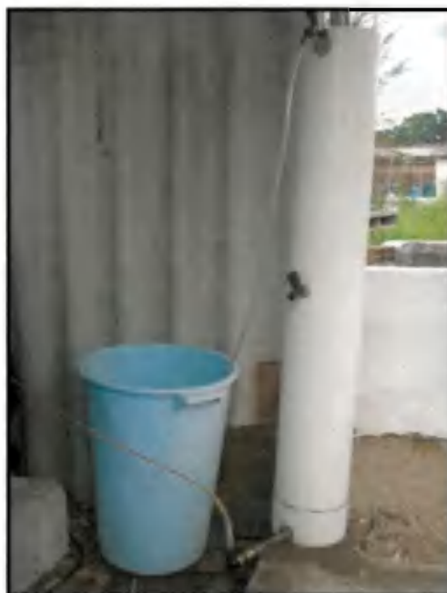
Figura 2. Reator UASB utilizado para o tratamento da água residuária utilizada no experimento
