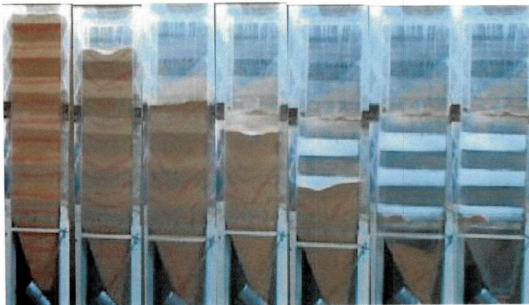
FIGURA 22: Comportamento do fluxo da ração 1, para T1 = 0 , H/L = 3,5 , STD2 = 64 \text{ cm}^2
