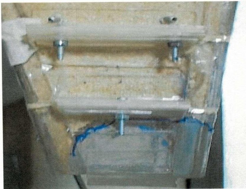
Figura 20: Formação do arco coesivo para ração 1, H/L = 5,3 e STD1 = 42,25 cm^2
