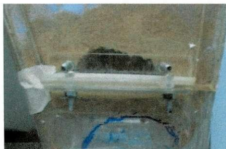
Figura 40: Formação do arco coesivo para ração 2, T_2 = 12\text{h} , H/L = 3,5 e \text{STD2} = 64\text{ cm}^2
