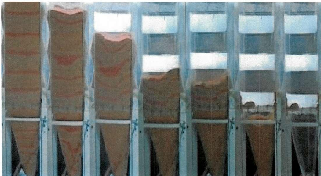
Figura 18: Comportamento do fluxo da ração 1, para T_1 = 0 , H/L = 1,76 , STD_1 = 42,25 cm 2
