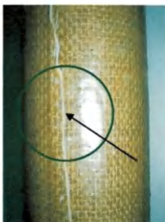
Figura 34 - Compósito tubular após ensaio de pressão hidrostática
