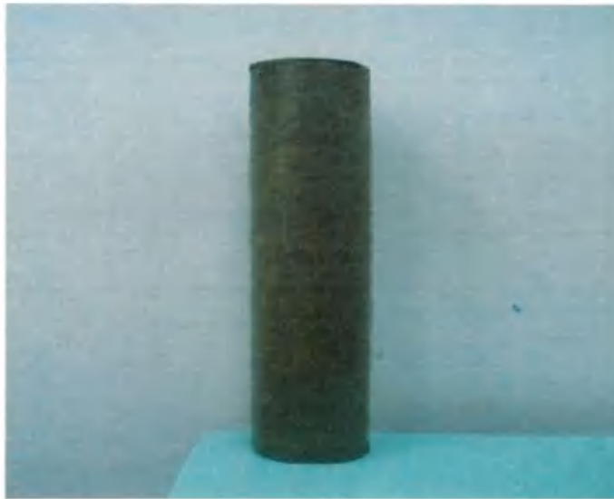
Figura 12 – Compósito tubular com quatro camadas de tecido de juta para ensaio de pressão hidrostática, resistência à compressão e ao impacto
