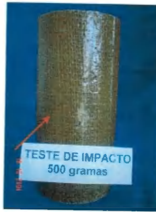
Figura 30 - Compósito tubular após ensaio de resistência ao impacto com peso de 500 gramas
