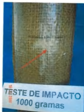
Figura 31 - Compósito tubular após ensaio de resistência ao impacto com peso de 1000g
