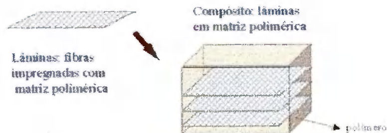
Figura 6 – Ilustração de compósito laminado.
