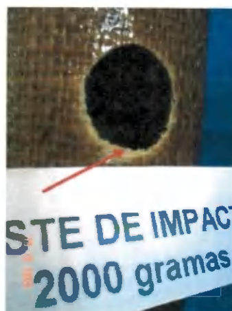
Figura 33 - Compósito tubular após ensaio de resistência ao impacto com peso de 2000 gramas
