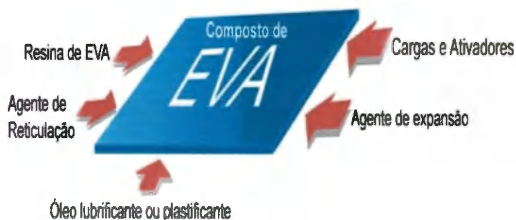
Figura 5. Configuração típica de uma placa expandida de EVA (Rolin, 2002)
