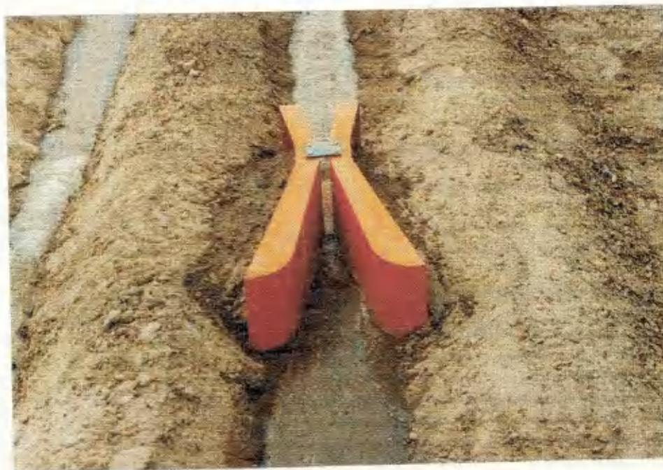
FIGURA 3. Ilustração da calha Parshall utilizada na determinação da vazão
