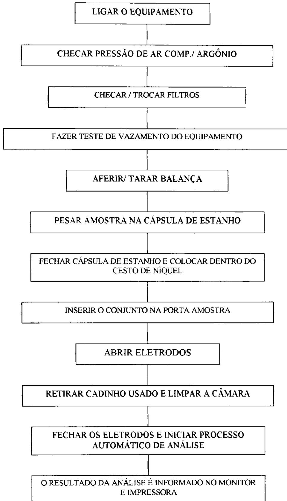
Figura 3.9 – Fluxograma dos procedimentos para análise do teor de alumina no LECO.
